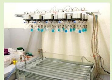
Abb. 1: Apparatur für die Messung der Bodenatmung
